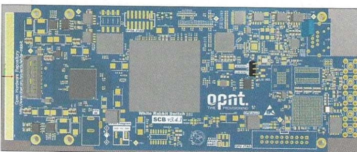
8 Die Low-Jitter Daughter Card für den 18-Port-Switch WRS-318 v3.4.
