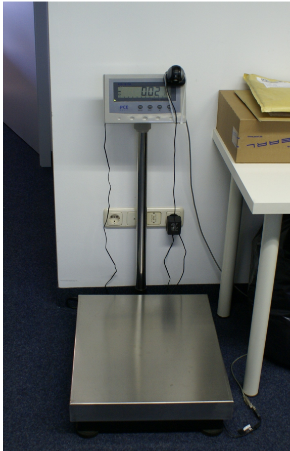
Abbildung 59: Warenannahme mit Waage und Kamera
