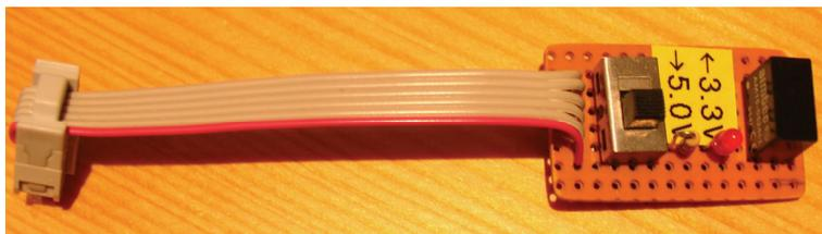
Abbildung 12 – Level-Converter-Board, Vorderseite
