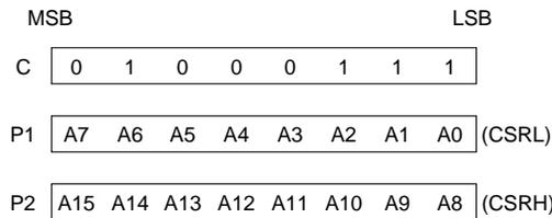
Figure 23. CSRR parameters
