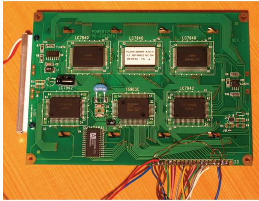
Abbildung 15 – Powertip PG240128-A, Rückseite
