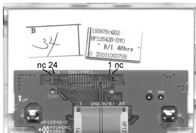
Der Anschluß des Displays erfolgt über einen 24-poligen Folienleiter. Wenn ein geeigneter Steckverbinder nicht zur Verfügung steht, kann der Folienleiter vorsichtig vom Display abgezogen und dünne Drähte auf die Kontaktflächen des Displays aufgelötet werden. Hierbei ist zu beachten, das sich auf der Displayplatine links und rechts jeweils ein nicht numerierter Kontakt befindet.
