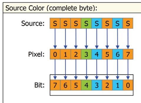
Abbildung 47 – ROPs, Source Color (komplettes Byte)
