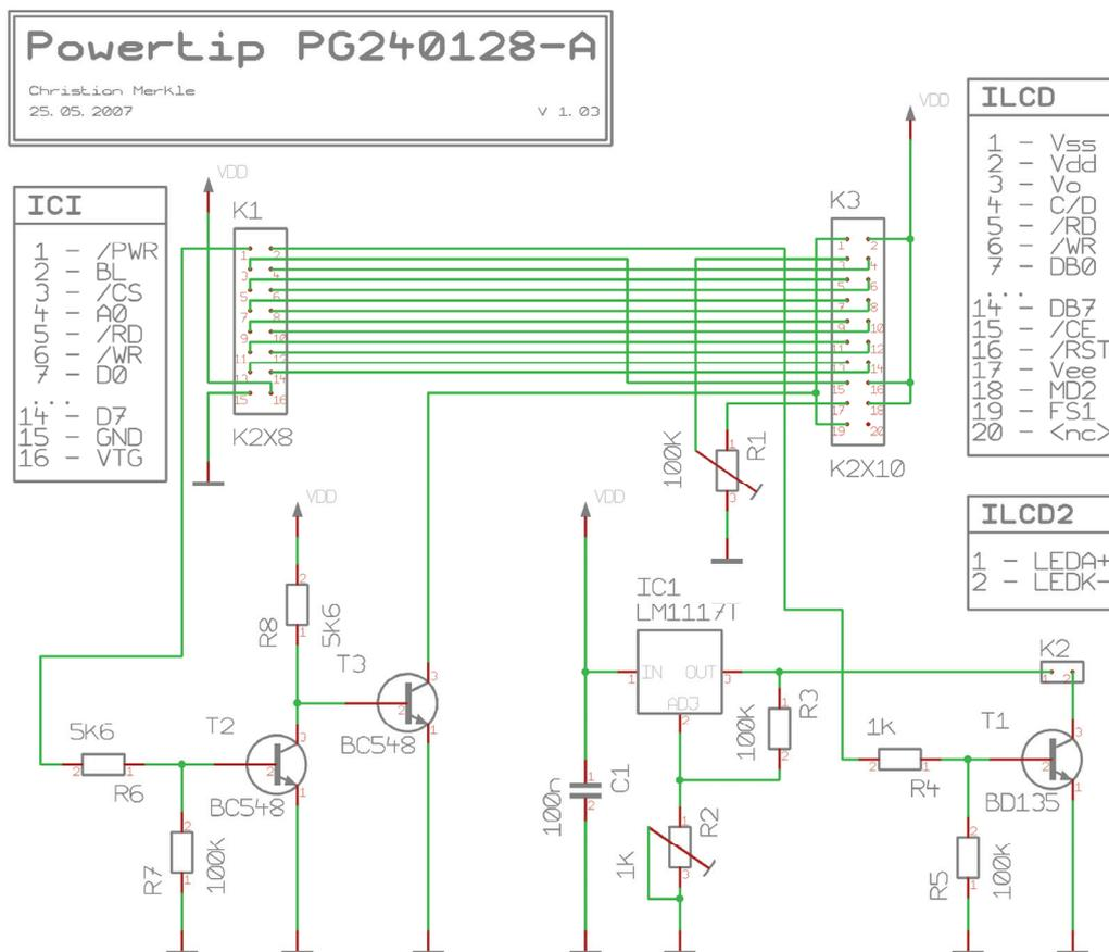
Abbildung 16 – Schaltplan PowerTip PG240128-A
