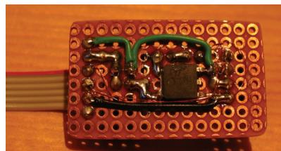
Abbildung 13 – Level-Converter-Board, Rückseite
