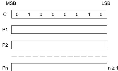
Figure 24. MWRITE parameters
