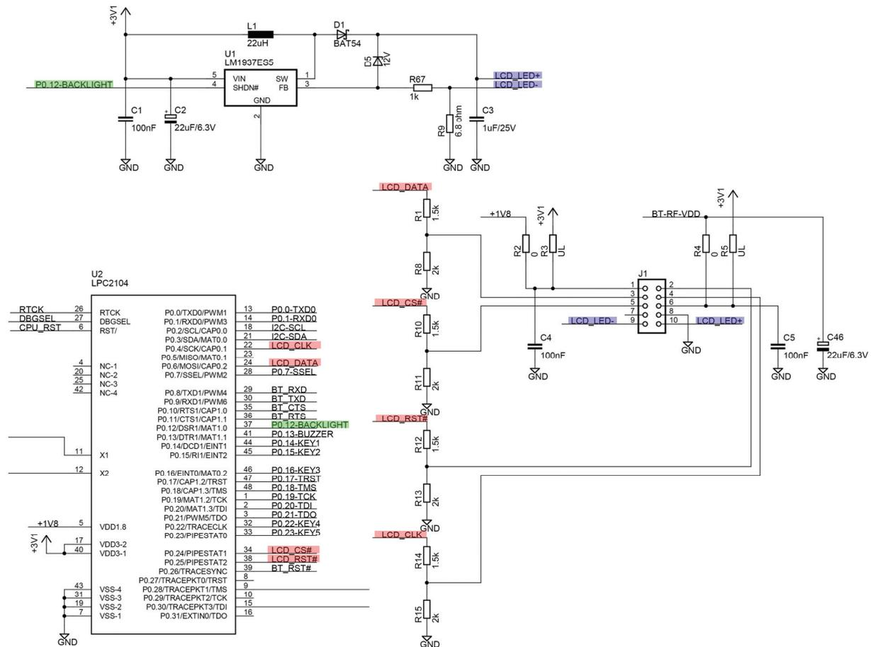
Abbildung 33 – Schaltplan (teilweise, LCD-relevant) Embedded Artists Board, aus [EMBART]
