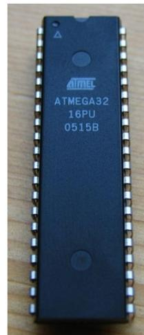
Abbildung 4 – Atmel AVR Mega32
