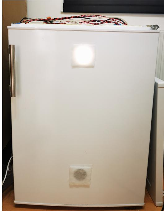
**Abbildung 3.3:** Befestigte Filtermatten an der Außenseite der *Growfridgetür*
