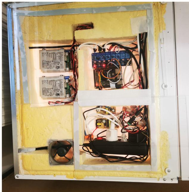
**Abbildung 3.4:** Test der Kühlung nach eingebauter Schaltung
