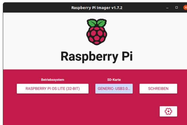
**Abbildung 3.1:** *Raspberry Pi Imager* v1.7.2 nach der Auswahl des Betriebssystems und der SD-Karte
