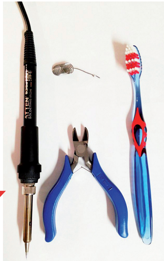
Abb. 1: Werkzeuge für den Zusammenbau des Helvetino: LötKolben ab 25W, Seitenschneider, 5 - 10g Lötzinn, Zahnbürste
