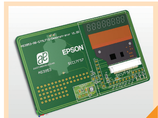
Abb. 3: E-Paper Demokit für AS3953 (Quelle: ams Schulungsunterlagen)
