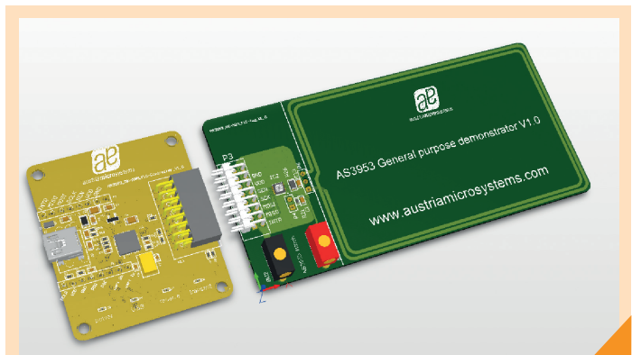
Abb. 2: General Purpose Demokit für AS3953 (Quelle: ams Schulungsunterlagen)
