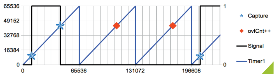
Abb. 4: Verlauf von Signal, Timer1 und die Erfassungs-Zeitpunkte (Capture)
