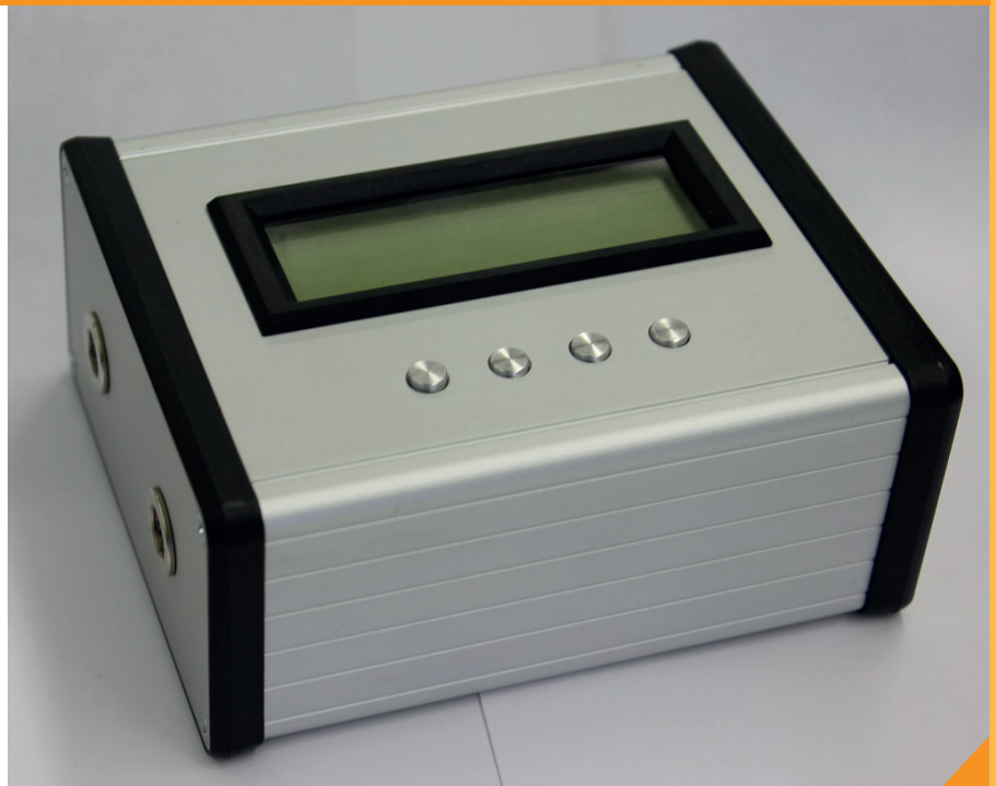
Abb. 1: Batteriemonitor mit Dual Slope Wandler in Gehäuse
