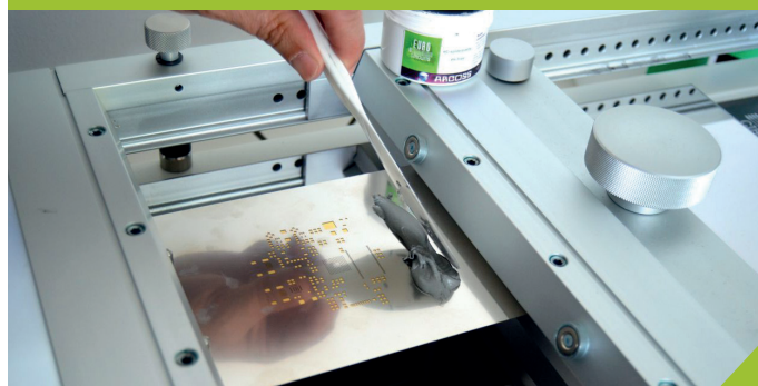
Abb. 3: Vorsichtiges Auftragen der Lötpaste
