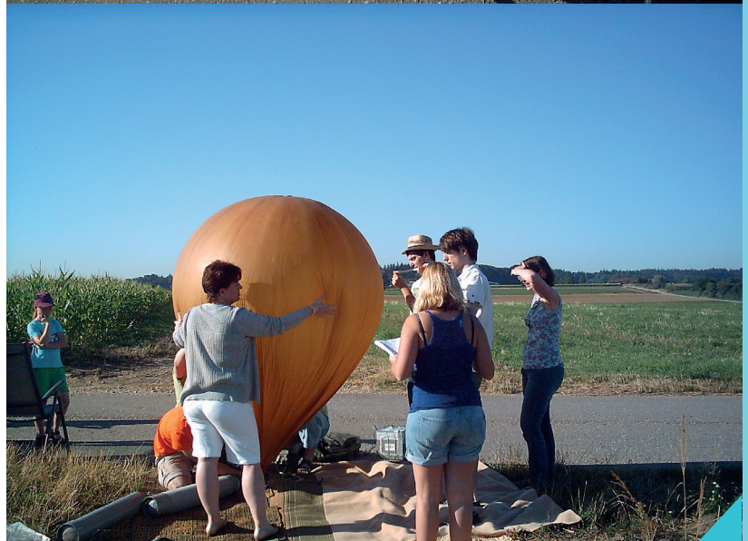
Abb. 6: Aufblasen des Ballons mit zwei Helium Gasflaschen
