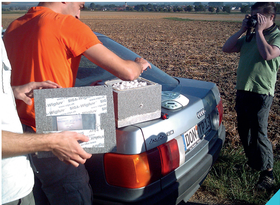
Abb. 2: Die Transportbox wird zur zusätzlichen Wärmeisolierung mit Styroporkugeln aufgefüllt
