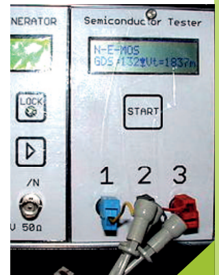
Abb. 3: Ausführung als Einschub für einen 19"-Baugruppen-träger, versorgt über einen Netztrafo, ohne Abschaltautomatik
