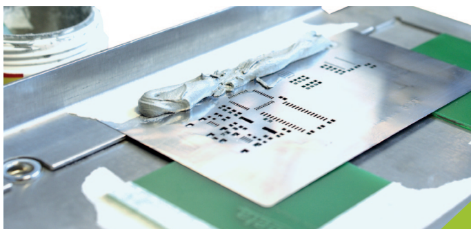
Abb. 6: Schablone und Platine beim Rakeln auf einer Metallunterlage. Gut zu sehen ist hier die „Pastenwurst“
