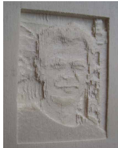
Abb. 11: In Sperrholz gefrästes Foto
