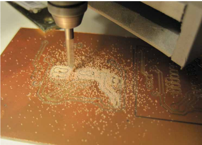
Abb. 10: Fräsen eines Layouts
