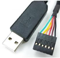
Der Stecker passt auch bereits auf den BBB UART Steckverbinder. Das schwarze Kabel ist die Masse. Der `lsusb` Befehl listet dieses Kabel als
