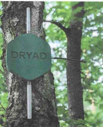
Das Silvanet Border Gateway ist der Broker für die Kommunikation zwischen den Lora-Mesh-Netzwerken und dem Internet
