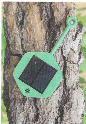
Jeder einzelne Sensor misst verschiedene Umgebungsparameter und meldet sie über einen integrierten LoRaWAN-Transceiver. Solarstrom liefert die Energie.
