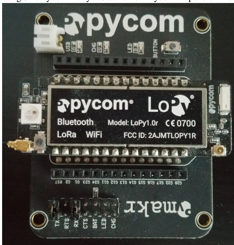
Abbildung 3.1: Pycom LoPy 1.0 auf einem Pycom Expansion Board 2.1
