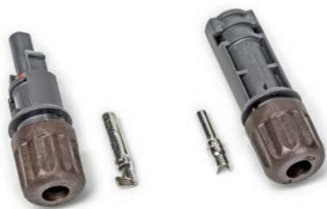
Die Zuordnung von Stecker und Hülse ist entscheidend: In den männlichen MC4-Stecker (links) gehört die Hülse mit dem größeren Durchmesser.
