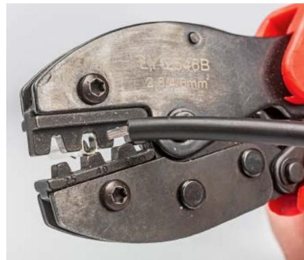
**Übungssache: Die Zange so festhalten, dass die Hülse darin hält. Die offene Seite der Hülse zeigt in Richtung der Pressbacke, die wie ein flaches W geformt ist. Mit der anderen Hand führt man das abisolierte Kabel ein.**
