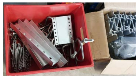
Die Dachhaken, Profile und Module lieferte uns der Solarteur, mit dem wir handelseinig wurden.
