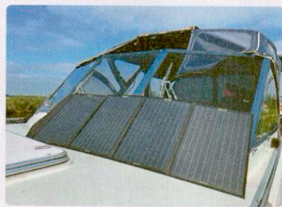
Bild 9. Das von Martin und Detlev verwendete faltbare Solarpanel liefert 120 Wp und wird bei Fahrt unter Deck verstaut (Bild: Martin Jepkens).
