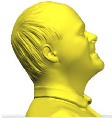
Dreht man den aus einem Scanstammenden Kopf nach hinten, bleiben die Überhänge in einem ohne Stützstrukturen druckbaren Rahmen (Abb. 11).
