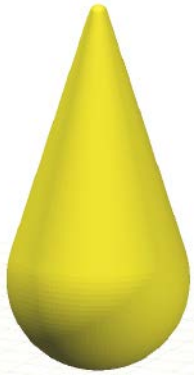
Manche Objekte lassen sich ohne zusätzlichen Aufwand nur schlecht stabil auf dem Druckbett positionieren (Abb. 8).
