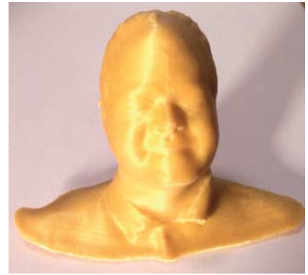
Vor allem PP neigt beim Abkühlen zum Verziehen, hier links zu erkennen (Abb. 1).
