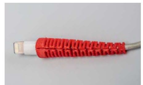
Die Lösung: Der selbst gedruckte Knickschutz verhindert Abknicken und Kabelbruch.
