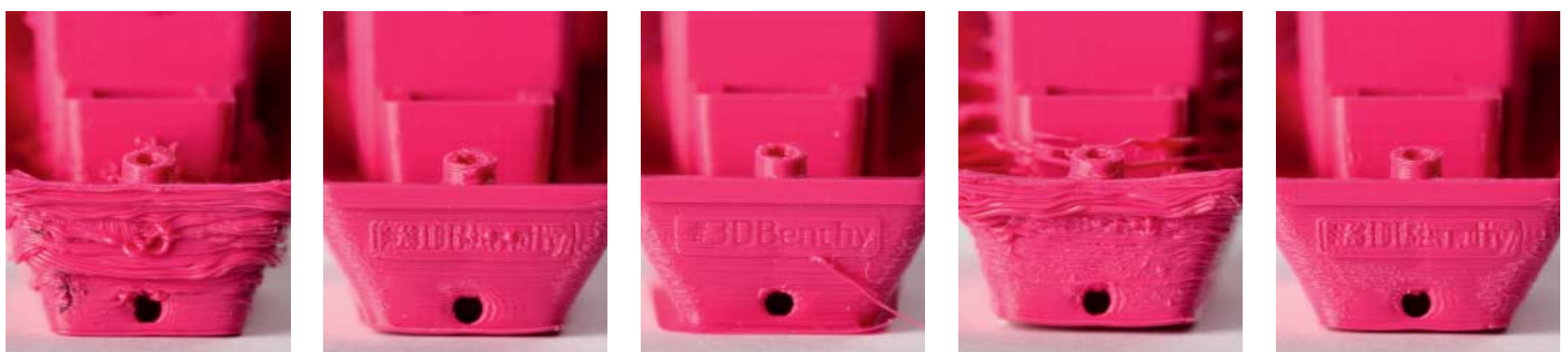
Das Heck von 3DBenchy zeigt nach dem Druck mit AstroPrint Desktop, Cura, IceSL Slicer, MatterControl und Simplify3D (von links nach rechts) unterschiedlich gut ausgeprägte Details.
