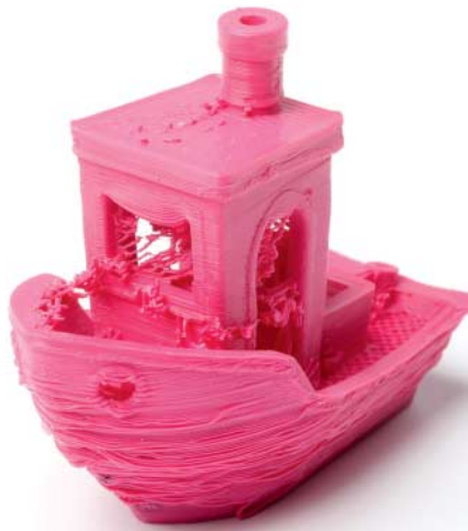
Das mit AstroPrint gedruckte Schiffchen zeigt viele Mängel.
