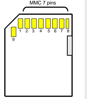
Pin 1Data 3Pin 2CommandPin 3VssPin 4VddPin 5ClockPin 6VssPin 7Data 0Pin 8Data 1Pin 9Data 2
