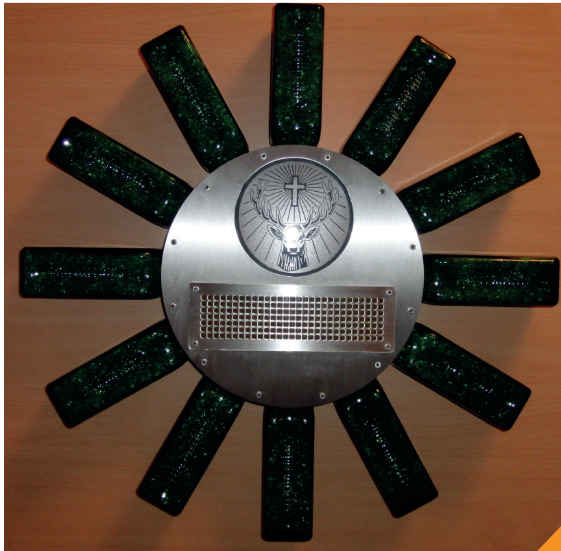
Abb. 6: Die fertig aufgebaute „Jägermeister-Uhr“ mit der LED Matrix als Display
