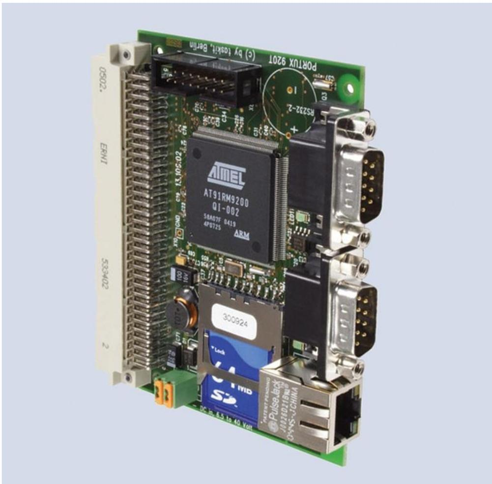
**Abbildung 1:** Der Workshop verwendet als Beispiel für die Zielplattform ARM. Im Bild der ARM-Singleboard-Computer Taskit Portux920T mit dem Controllerchip Atmel AT91RM9200, zwei seriellen Schnittstellen, 100 MBit/s Ethernet und JTAG-Unterstützung.
