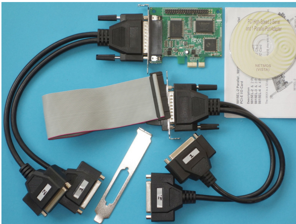
Abbildung 4: Die Low-Profile-PCIe-Karte TP35 ist auch bekannt unter der Bezeichnung 9815EL-4, kostet zirka 50 Euro und besitzt dank ihrer vier Parallelports bis zu 52 Eingangspins.
