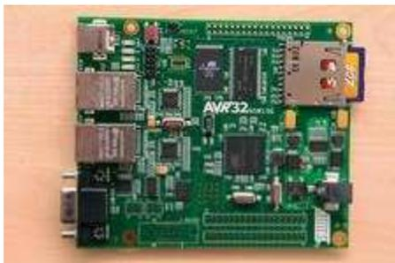
Abbildung 1: NGW 100, ein Beispiel für ein Linux-Board mit AVR32-Prozessor, 140 MHz Takt und 32 MByte RAM.
