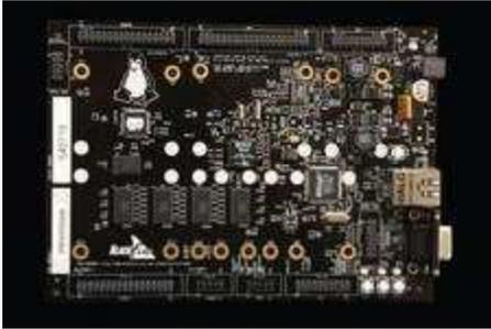
Abbildung 2: Als weiteres Beispiel das Linux-Board Blackfin Stamp mit einem 533-MHz-DSP, aber ohne MMU.
