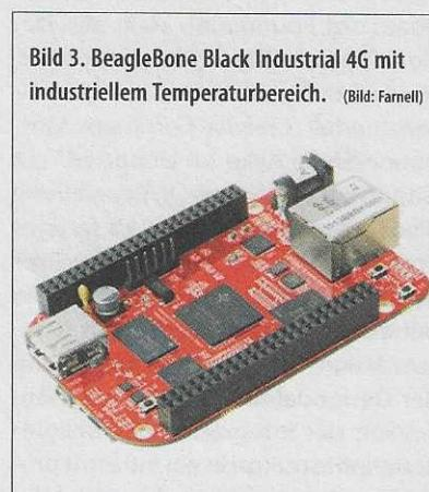
Bild 3. BeagleBone Black Industrial 4G mit industriellem Temperaturbereich. (Bild: Farnell)
