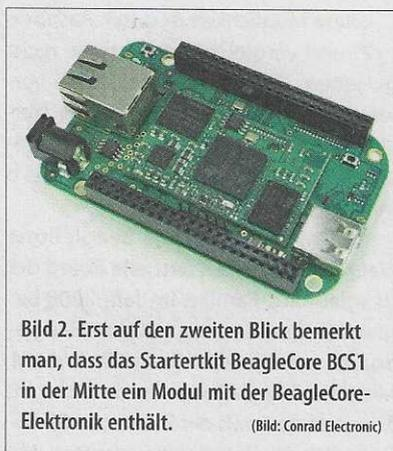
Bild 2. Erst auf den zweiten Blick bemerkt man, dass das Starterkit BeagleCore BCS1 in der Mitte ein Modul mit der BeagleCore-Elektronik enthält. (Bild: Conrad Electronic)
