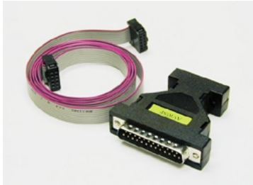
Abb. 05: ISP-Adapter für die parallele Schnittstelle
